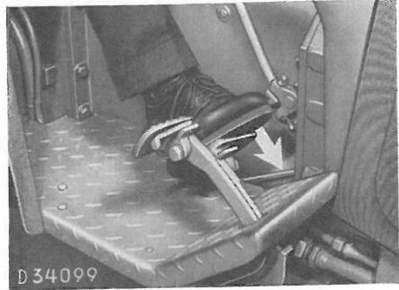
fig. 70 Maniement du frein de direction
