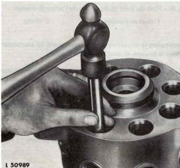
Fig. 6 – Extraction des sièges de clapet de refoulement
