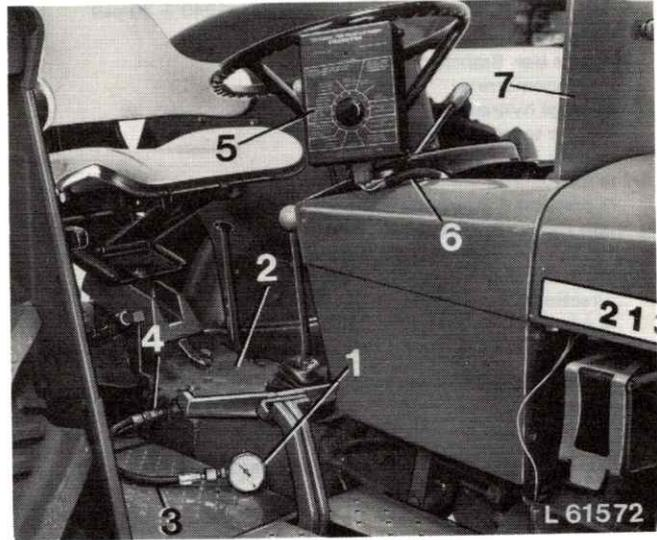
Fig. 2 — Manomètre branché sur le relevage et appareil de contrôle branché sur le faisceau de l'essieu avant moteur (sur 2130 sans cabine)
