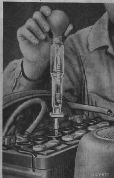
Contrôle de la densité des acides et de l'état de charge de la batterie
