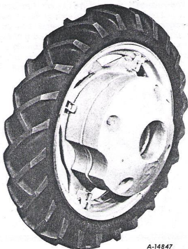
Figure 94 - Premier et deuxième poids de roue arrière fixés sur roue.
