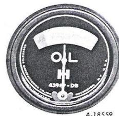
Figure 6 - Manomètre de pression d'huile montrant l'aiguille en position correcte de fonctionnement.
