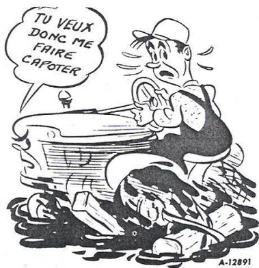
Si le tracteur ne peut pas se déplacer parce que les roues arrière sont enterrées ou enfoncées profondément dans le terrain, n'attachez pas de bûches, de pierres ou autres objets aux roues arrière en les empêchant de tourner. Vous êtes certain de capoter.....
