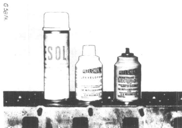
Figure 35 Contrôle des fissures
