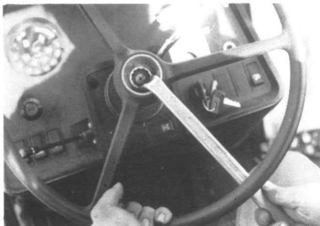
Retirer l'écrou du volant.
