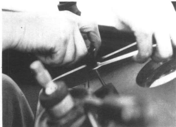
Mettre le passe-fil de la commande d'arrêt du moteur et fixer le contre écrou et le bouton.
