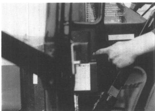
Fixer le tablier du tableau de bord en poussant sur les boutons de retenue.
