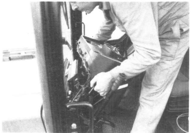
Soulever le tableau de bord sans débrancher les fils.
