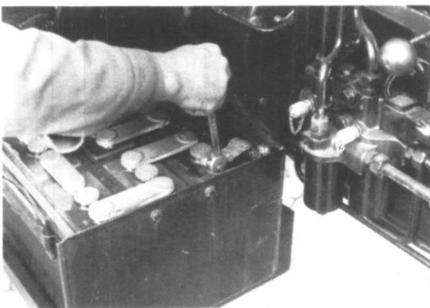
Brancher le bac d'accumulateur et le fermer. Retirer les cales des roues arrière.
