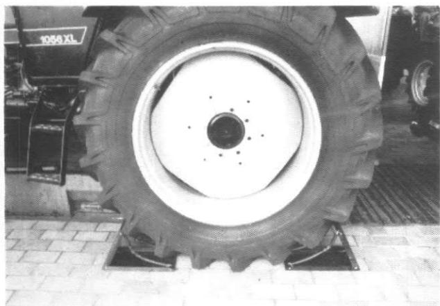
Mettre des cales à l'avant et à l'arrière des roues arrières.
