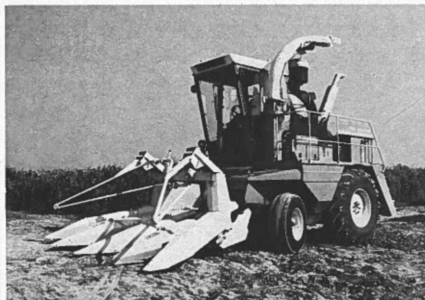
Cette ensileuse automotrice Hesston « 7680 » (homologuée Code de la Route) est équipée d'un moteur General Motors de 280 ch
