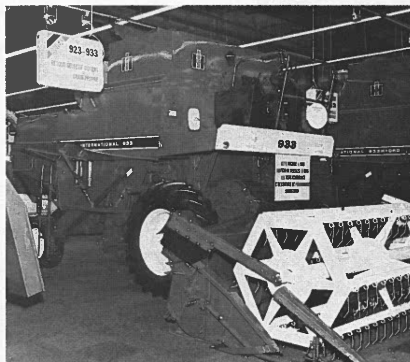
NOUVELLE M.B. IH « 933 » 120 ch DIN - 8 à 10 tonnes/heure (Photo RTMA)
