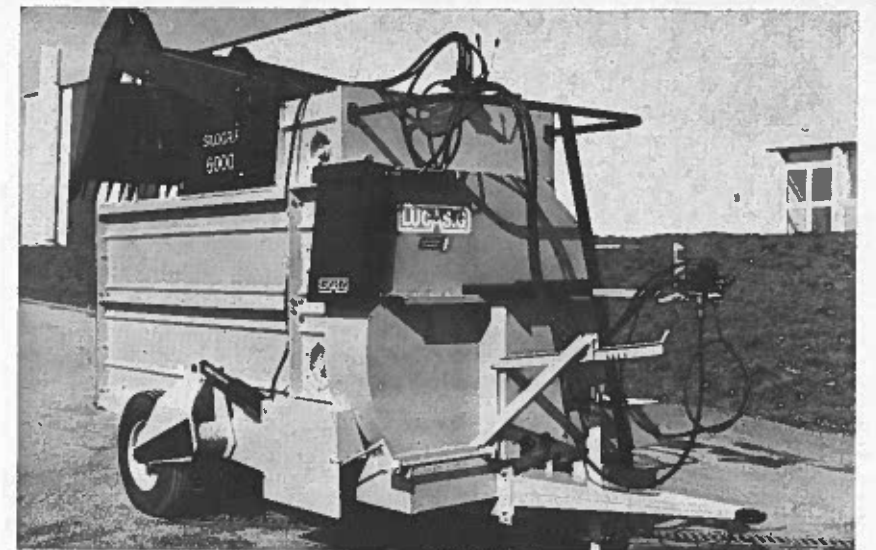
LA DISTRIBUTEUR PAILLEUSE LUCAS EN POSITION TRANSPORT, ROUES ABAISSÉES ET VOILET DE LA TURBINE RABATTU
