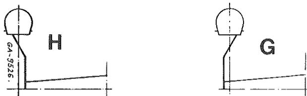
Figure 26 - Largeur de voie avec roues à voile.
