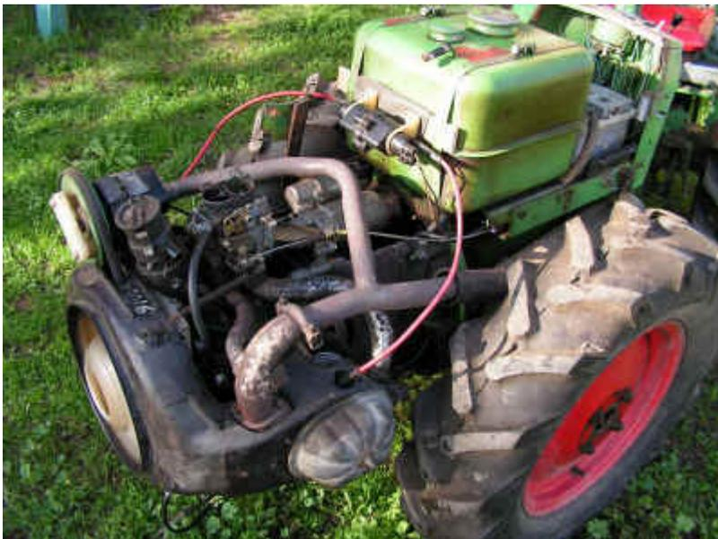
On voit ci-dessus que j'ai mis une grande poulie (de ventilateur) sur l'alternateur, avec une cale en téflon : c'est pour entraîner la pompe hydraulique, qui sera montée en face, sur la calandre. Avec la poulie d'origine, ça tournait trop vite, l'huile chauffait et le relevage catapultait mes chargements en l'air !!! Si c'était à refaire, je monteraï cette pompe en face de l'axe du ventilateur, qui tourne à la bonne vitesse. C'est plus simple...
