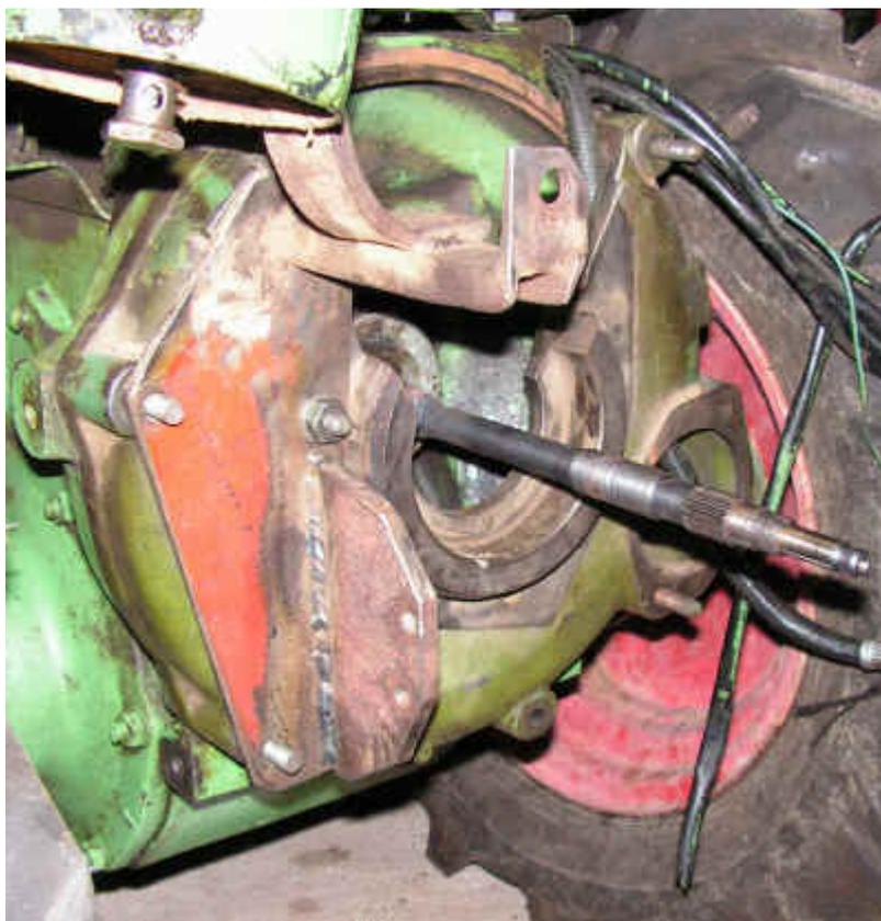
Fixer la cloche de 2 CV par ce premier support, avant de fabriquer le second. La cloche doit être calée à la bonne longueur, centrée et montée d'équerre par rapport à l'arbre. Pour le vérifier, j'utilise un volant d'embrayage centrifuge, monté sur l'arbre, et une réglette métallique maintenue sur le volant par un bon aimant. Lorsqu'on tourne le volant, l'équerre doit affleurer "pile poil" chacun des 4 supports de la cloche...
