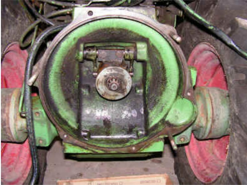
Couper, à la disqueuse, l'arbre de boîte de 2 CV au raz de son palier de roulement (voir ci-dessous, amorce de découpe à droite).
