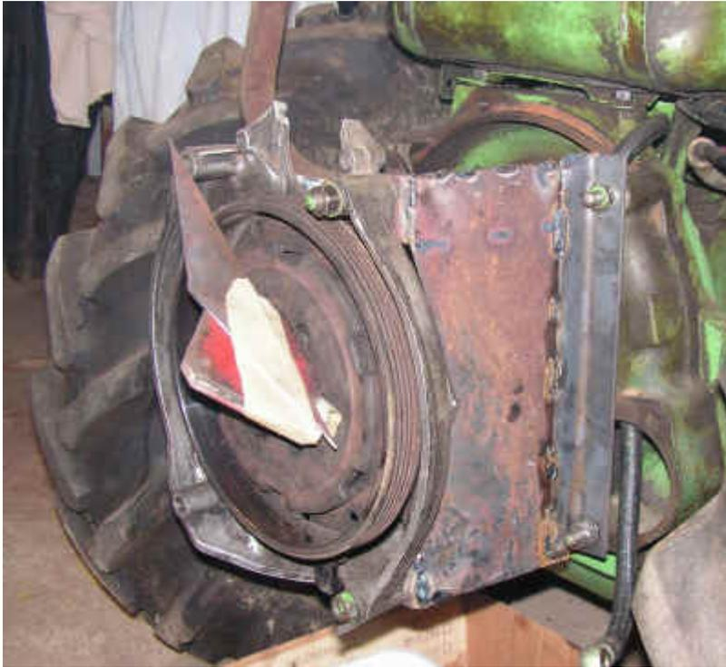
On peut alors monter le moteur et ses accessoires. J'ai réutilisé le pot d'échappement d'origine, ça va bien ; mais je ne suis pas trop fier de mon raccordement entre les 2 sorties d'échappement, à refaire "un jour" avec un beau coude envoyant les gaz du cylindre droit dans la bonne direction...
