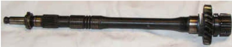
Le moignon de cet arbre de boîte est creux et impossible à usiner ; mais on peut ajuster l'extrémité de l'arbre de transmission du tracteur au même diamètre et à la même profondeur, pour bien aligner et centrer le tout. Je fais ça à la disqueuse, mais ce n'est pas facile. Chanfreiner le bout d'arbre de boîte, le pointer sur la transmission, aligner le tout "au quart de poil" (faire tourner) avant de souder le tout très solidement.
