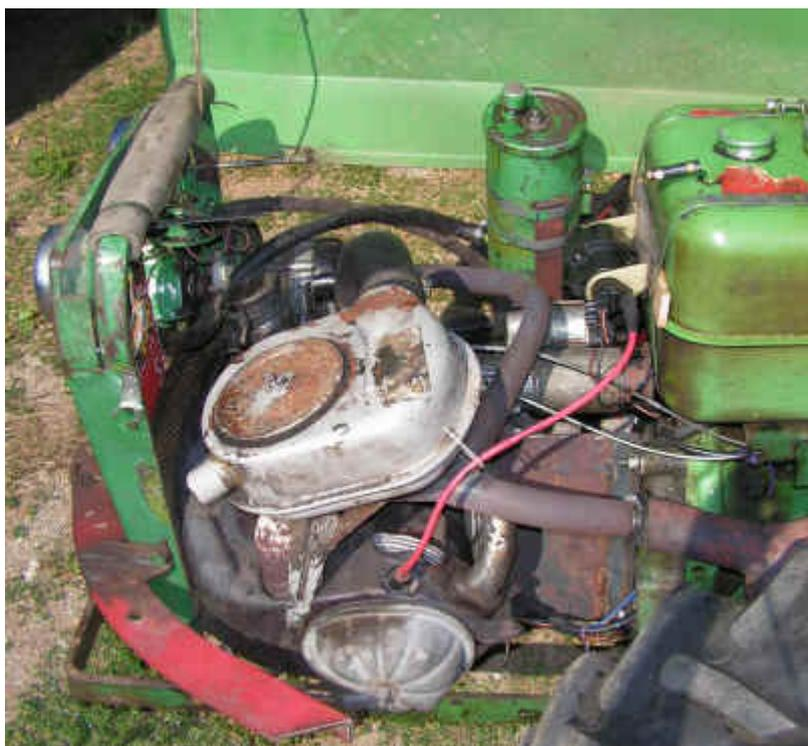
Détail de la pompe hydraulique : comme elle est fixée sur la calandre, impossible de la caler pile en face de l'alternateur. Pas grave, 2 ergots s'enfilent dans la fente du téflon montée sur la poulie de l'alternateur, ça tolère depuis plusieurs années les défauts d'alignement. Mais, je le répète, ce serait plus simple de la greffer sur l'axe du ventilateur (à l'avant, en bout de vilebrequin).
