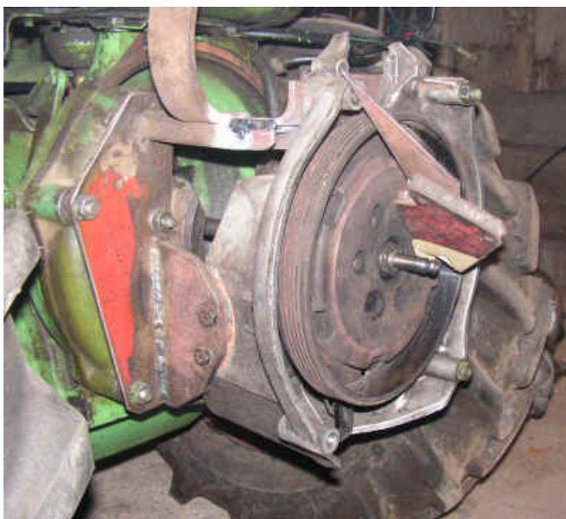
Fabriquer le second support avec une cornière, 2 équerres en fer plat et un bout de tôle (épais d'au moins 2 mm). Maintenir le tout avec des pince étau, vérifier tous les réglages, pointer solidement en place puis souder à l'établi.
