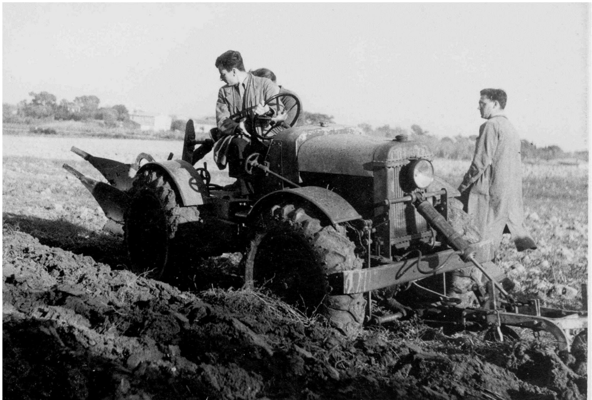
En 1951, à Villard les Dombes, démonstration d'un 4 roues motrices avec pont articulé
