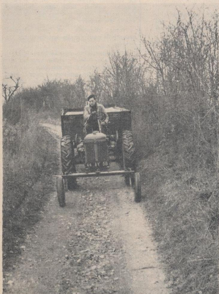
Epreuve de freinage sur chemin rural en descente. (Les sacs de chaux employés pour lestage permettent de faire varier facilement la charge.)
