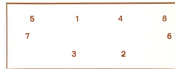
Ordre de serrage des écrous de culasse
