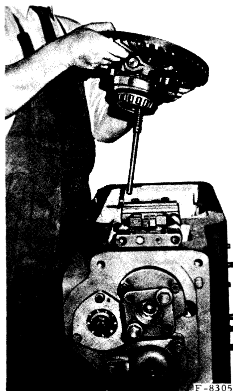
Fig. 21. — Dégagement de la couronne avec le boîtier de différentiel.
