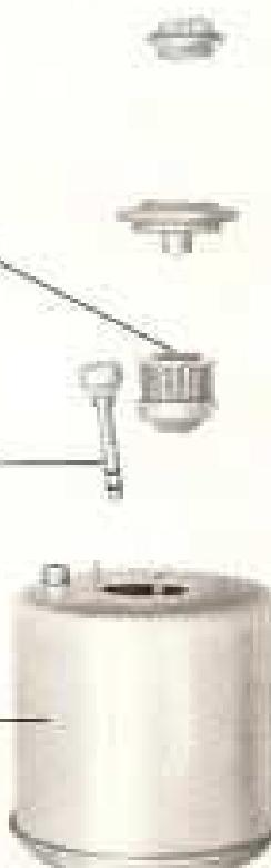
**ATTENTION :** Pour compléter un manque ou effectuer un remplissage, il est obligatoire d'effectuer cette opération, moteur arrêté et accessoire au sol ; pour ce faire, appuyer sur les trois manettes du distributeur. Dans ces conditions le niveau d'huile doit être au maximum de la jauge.
