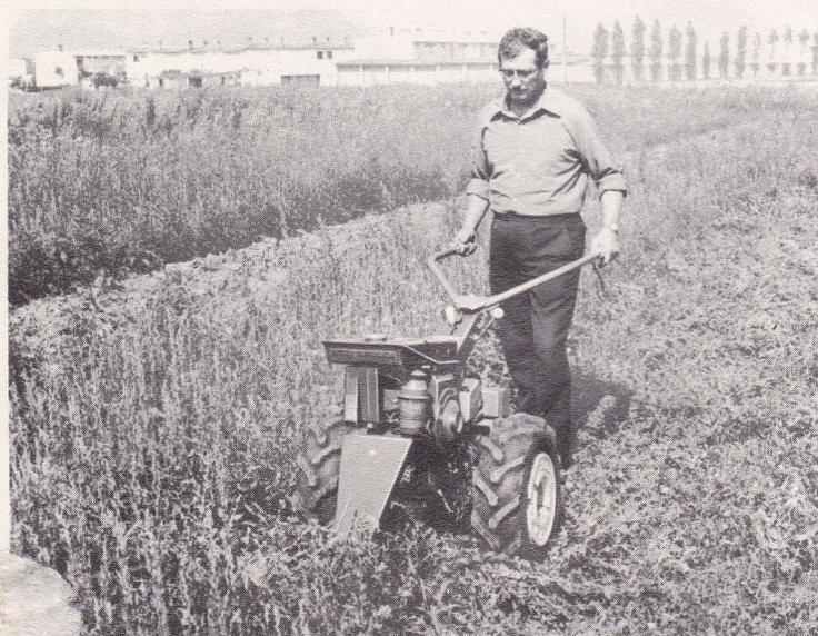
ment conçu pour l'entretien de petites propriétés, le BOUYER 223 peut aussi être utilisé comme un bon faucheur-débroussaillier.
