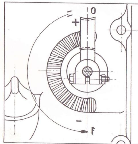
Si l'on constate que le régime baisse immédiatement, laisser le levier à sa position d'origine; sinon positionner le levier de vitesse en le ramenant dans le sens O.F. jusqu'à ce que l'on constate une baisse de régime.
