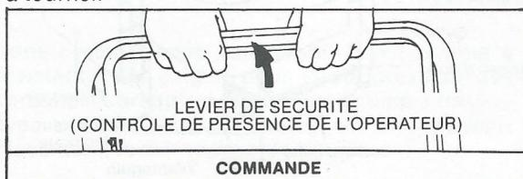
**DEMARREUR ELECTRIQUE.** Actionner et maintenir le levier de sécurité et tourner la clé, comme indiqué par le constructeur de l'équipement, pour lancer le moteur. Répéter l'opération, si nécessaire, avec le levier de commande en position FAST (marche). Lorsque le moteur a démarré, amener le levier de commande sur la vitesse désirée.
