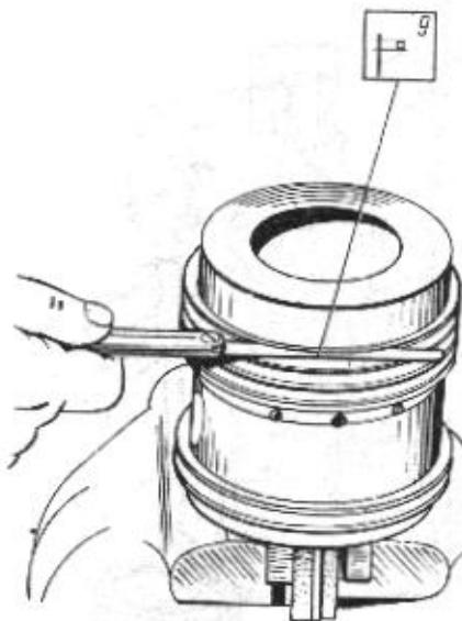
4. Новые поршень и цилиндр подбирайте одной маркировки. Она нанесена на выемке цилиндра под шпильку, около нижнего ребра, у поршня – на его днище
