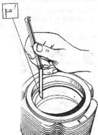
1. Проверьте зазор в стыке кольца. Он должен быть более 0,4 мм
