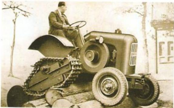
Sur ce cliché, datant du début des années 1950, le A22 est doté de son capot moteur, mais également équipé d'un train chenillé. Un dispositif principalement utilisé par les forestiers ou quelques fermes en haute montagne.
