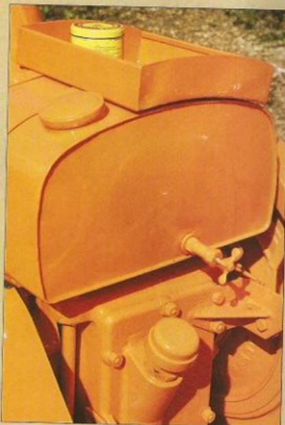
Cette vue arrière du bloc-moteur permet d'observer la plaque amovible de celui-ci. Le bouchon de remplissage situé sur sa gauche est dédié au remplissage de l'huile moteur. En haut, vous reconnaitrez aisément le réservoir de carburant, surmonté ici d'un petit support métallique, destiné à installer une caisse à outils. Ce type d'ajouts était répandu à l'époque.
