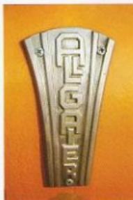
■ *L'insigne Allgaier en aluminium coulé, fixé sur la célèbre bouillotte qui permet de refroidir la mécanique par évaporation.*
