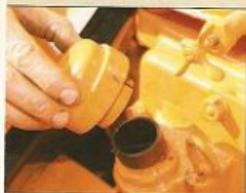
La remise à niveau en huile moteur se fait par l'arrière du bloc. À droite de la goulotte de remplissage, on distingue la tête de la jauge à huile, et en amont le robinet de carburant.
