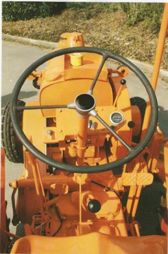
La planche de bord : le bouton situé à gauche commande les clignotants. Sur la droite, le bouton de commande du système d'éclairage, un témoin de charge et un ampèremètre de marque OS.
