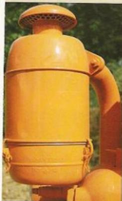
L'un des signes marquant des modèles A22, concerne la position du filtre à air à l'avant du moteur, qui pouvait être sur le côté droit sur les R22 d'origine.
