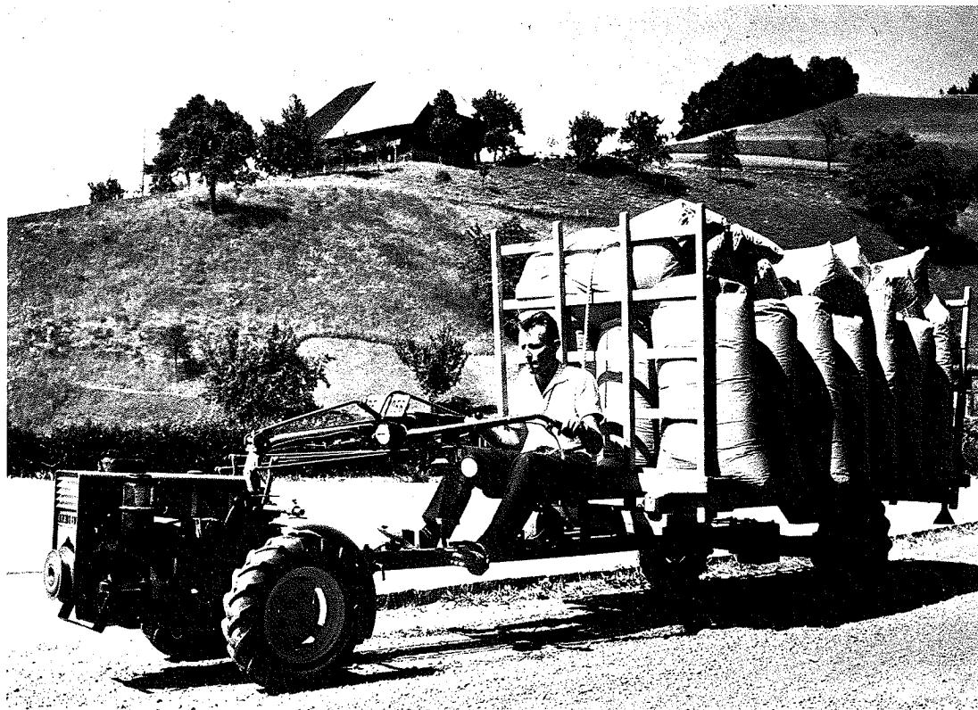
**Triebachsanhänger zu AM 30 und AM 80 1200 kg**
